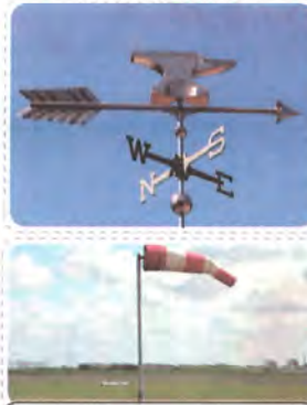
دوارة الرياح وجورب الرياح لتحديد اتجاه الرياح.
